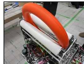
リングを射出する部分は、水道工事などで用いられる塩化ビニルのパイプを使用しました。表面にはざらざらした壁紙を。
